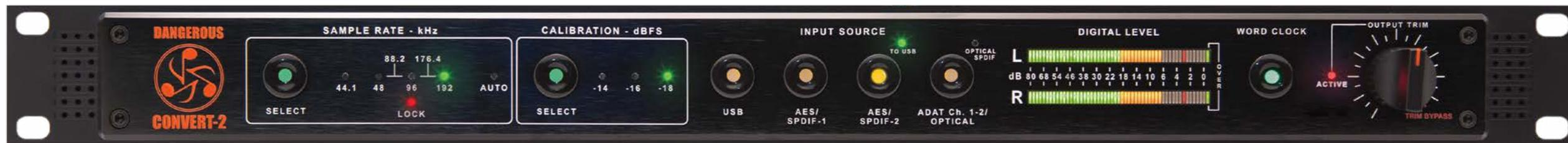
**Il pannello frontale di Convert-2 diviso in cinque sezioni da sinistra verso destra sample rate, calibration, input source, digital level, word clock e output trim**
